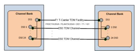
Figure 14-4 DS1 Channel and Device Interface Hierarchy
