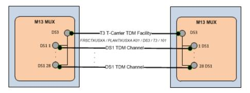
Figure 14-5 DS3 Channel and Device Interface Hierarchy
